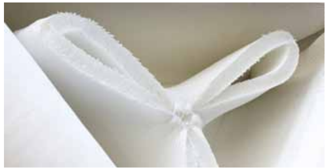
Detail Knoten aus Abstandsgewirke, SpacerFabric-Pavilion
